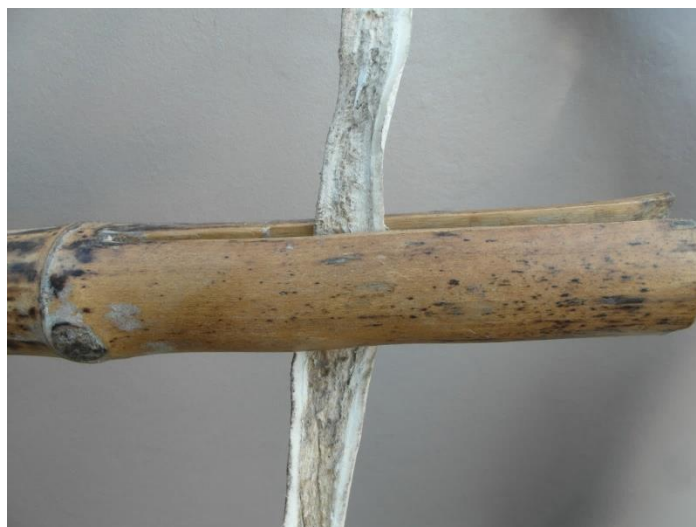
Figuur 8-12: Oopvlek van klaar gebreide rieme met 'n klemhout. Marius Oosthuysen-fotoversameling
