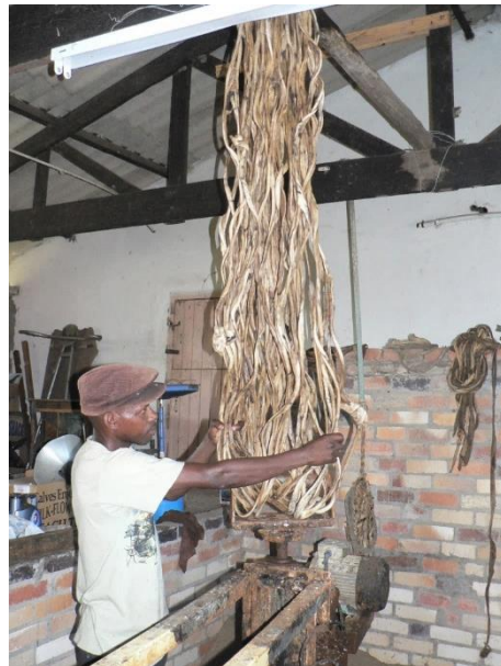
Figuur 8-9: Oopsprei van die breisel om af te droog tydens die breiproses Marius Oosthuysen-fotoversameling
